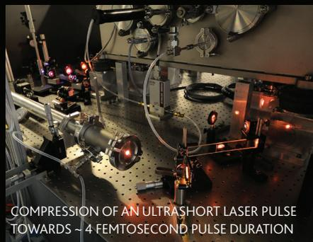
COMPRESSION OF AN ULTRASHORT LASER PULSE TOWARDS ~ 4 FEMTOSECOND PULSE DURATION
